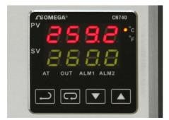
Zum Ändern bzw. Einstellen der Solltemperatur (unterer grüner Anzeigewert) drücken Sie die entsprechende Pfeiltasten 🗘 / 🔻 unter dem Display, die Sollwertanzeige beginnt zu flimmern. Durch Drücken der Taste 🖵 wird der eingestellte Wert übernommen. Der Sollwert wird nun als fester Wert, ohne Blinken, in der unteren Anzeige angezeigt.
