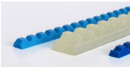
Verschweißbare Keilleisten werden häufig als Führungsprofile auf der Laufseite eingesetzt, um den Geradeauslauf von z.B. kurzen oder unterquadratischen Transportbändern zu unterstützen bzw. um Querkräfte bei seitlicher Produktaufgabe abzufangen.
