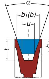
Für BEHAbelt-Keilriemen nach DIN 2215 sind Keilriemenscheiben nach DIN 2217 zu verwenden.
