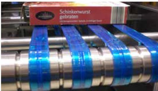
T-Profile eignen sich hervorragend zum Transport diverser leichter Güter und Lebensmittelprodukte, wobei in der Regel mehrere T-Profil-Riemen nebeneinander laufen. Der integrierte Führungskeil auf der Laufseite verhindert das seitliche Verlaufen der Profile und garantiert somit einen präzisen Geradeauslauf. Das Portfolio von BEHAbelt beinhaltet T-Profile in verschiedenen Geometrien, PU-Shore-Härten und Farbkombinationen.
