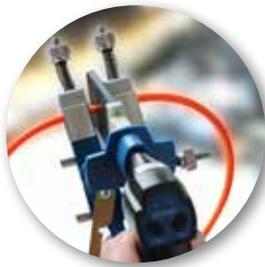
Präzises Verschweißen dank gleichbleibendem Anpressdruck.
