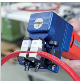
Schweiß-/Verbindungstechnik für PU und TPE
