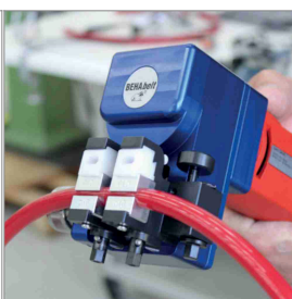
Schweiß-/Verbindungstechnik für PU und TPE
