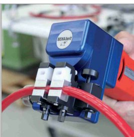
Schweiß-/Verbindungstechnik für PU und TPE
