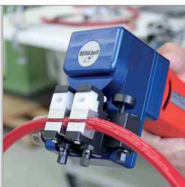
Schweiß-/Verbindungstechnik für PU und TPE
