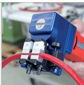
Technologia spawania/??czenia PU i TPE
