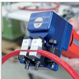
Technologia spawania/łączenia PU i TPE
