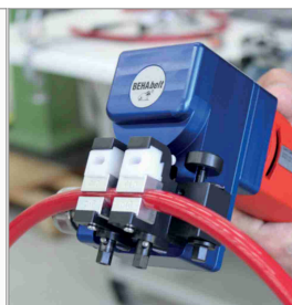
Schweiß-/Verbindungstechnik für PU und TPE
