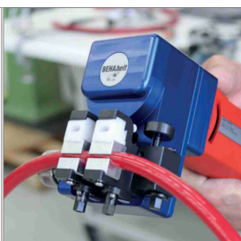
Tecnologia di saldatura/giunzione per PU e TPE
