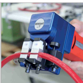
Tecnología de soldadura/unión para PU y TPE
